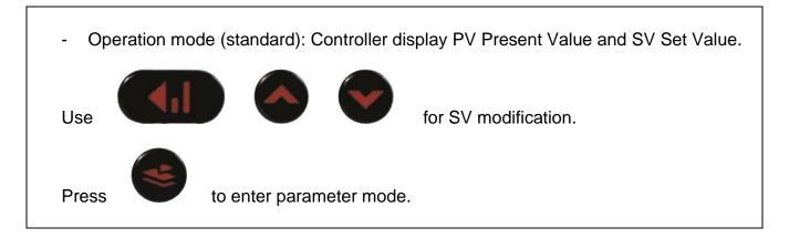
Parameter mode: Controller display parameter name, value and unit.
